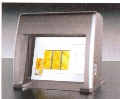
Egal von Kunststoff, Holz oder Textil – am Betrachterplatz können Hersteller Original und digitales Muster zuverlässig abgleichen
