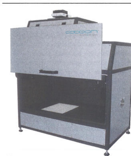
Abb. 1 Das multispektrale Aufnahmegerät can:scan erfasst Farben und Strukturen dreidimensionaler Objekte
