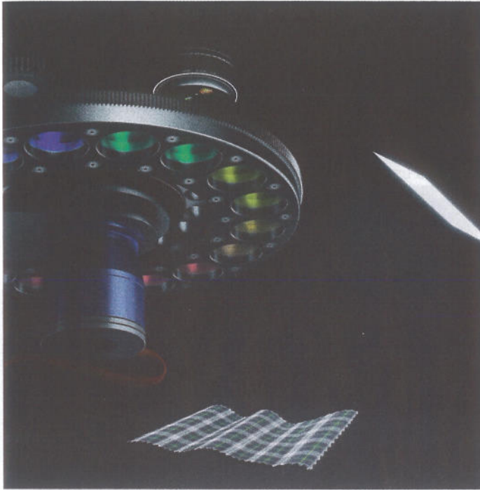
Im Scanner von caddon macht eine Kamera Aufnahmen durch 16 verschiedene Filter.
