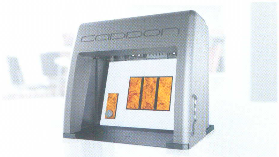
Bild 2. Am Abmusterungsplatz können direkt am Monitor Original und digitales Muster miteinander verglichen werden.
